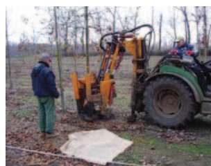
V této době končí ve školkách v Obříství expedice alejových stromů dobývaných se zemním balem dobývacím rýčovým strojem Damcon
