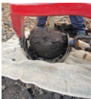
Ve Smržicích dobýváme stromy vibračním nožovým strojem Pazzaglia
