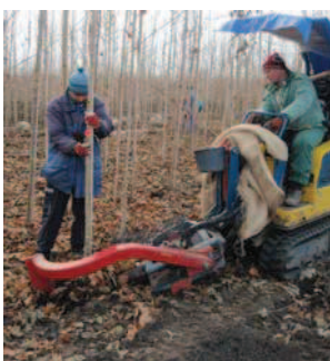
Ve Smržicích dobýváme stromy vibračním nožovým strojem Pazzaglia
